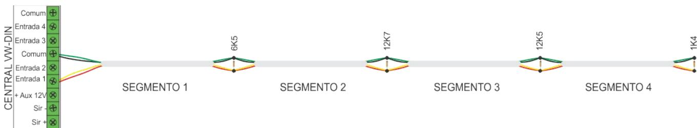
O modo 9 é uma forma de utilização especial das zonas. Desenvolvido especificamente para monitorar corte de cabos, permite detectar em qual dos 4 segmentos o cabo foi cortado.
