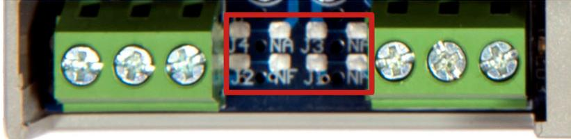
Note que as quatro ilhas da direita correspondem a PGM1 e as quatro da esquerda a PGM2. Há uma pequena trilha interligando J1 ao NF e J3 ao NA e caso ocorra a oscilação da lâmpada ligada na PGM1, são elas que devem ser rompidas.
